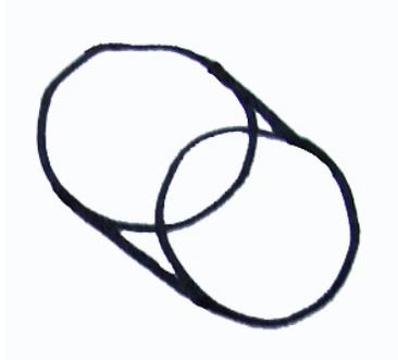
Figura 136. Cilindro isométrico.
