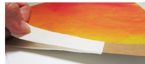
Foto 7. Retiro inadecuado de la máscara con movimiento perpendicular al sustrato.
